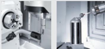
Dispositif de pré réglage automatique des outils intégré à la machine
