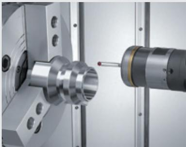
Dispositif de pré-réglage des outils incorporé
