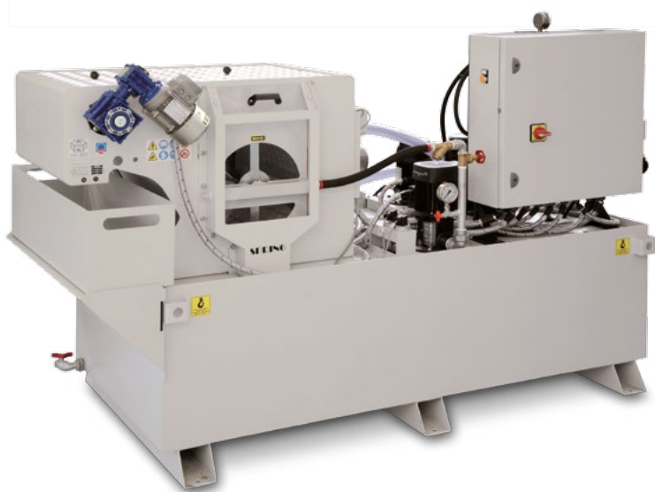
GRUPPO REFRIGERAZIONE VIA MANDRINO - 75 BAR Vasca 500 l - Filtro tamburo
