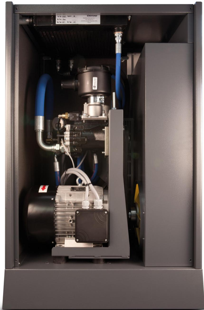
Das Gehäuse ist auf einem massiven Sockel aufgebaut und mit einfach entfernbaren Covern bedeckt um einen bestmöglichen Zugang zu gewähren. Die Abdeckungen sind auf der Innenseite komplett mit einem schallabsorbierendem Material bedeckt und zusätzlich mit einer waschbaren, Öl und Feuchtigkeitresistentem Folie überzogen.
