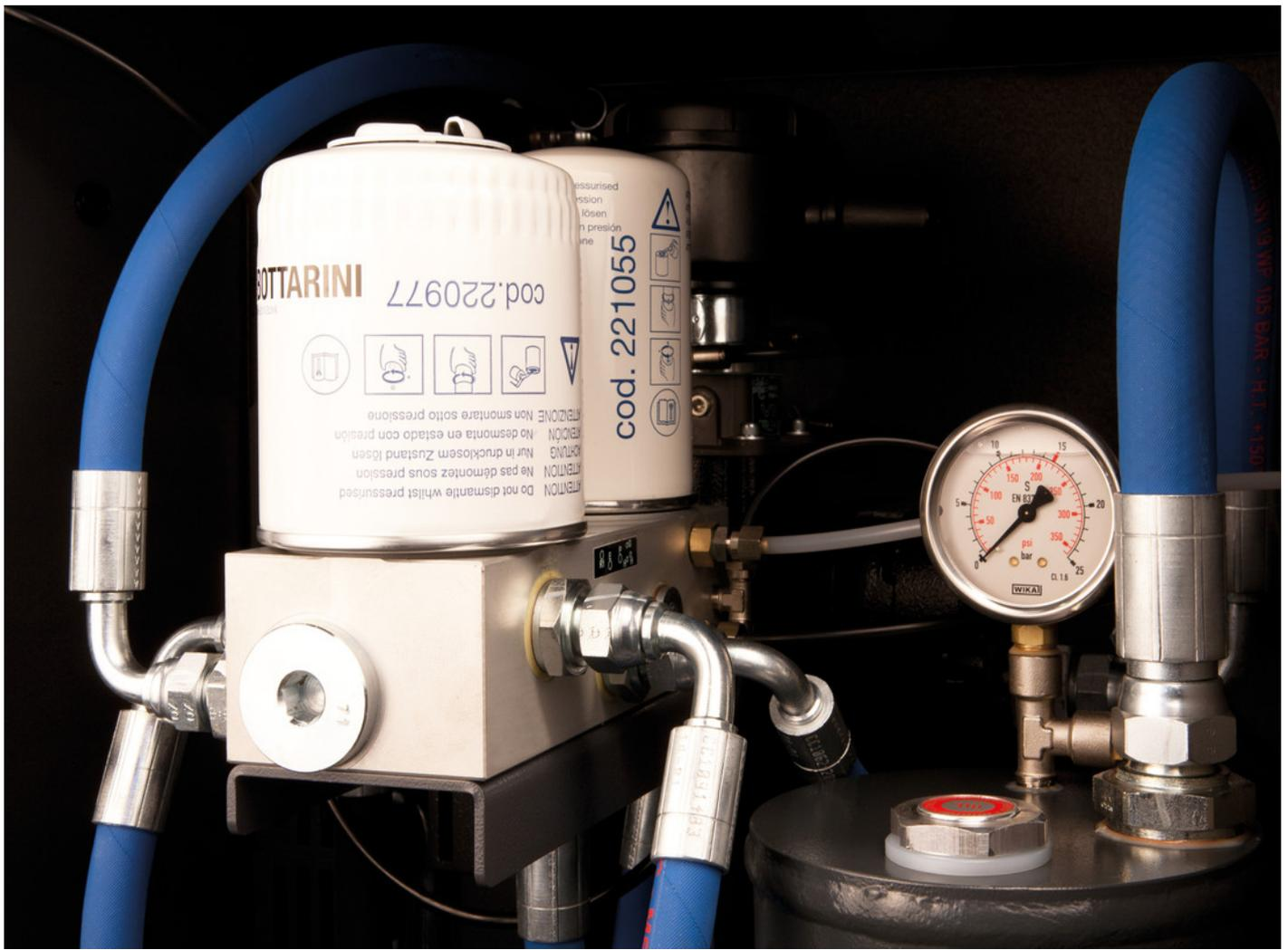
Grössere Verlässlichkeit und eine Reduktion von Leitungen dank dem Einsatz einer Blockeinheit, welche die Luft / Öl- Trennung sowie die Filterung übernimmt. Die effektive Filterung reduziert die Restölanteil auf maximal 3 ppm (Parts per million / Teilchen pro Million). Die Blockeinheit beinhaltet den Ölfilter, den Öl- Separationsfilter, das Mindestdruckventil, das Sicherheitsventil, den Ölthermostat sowie das Prüfventil.
