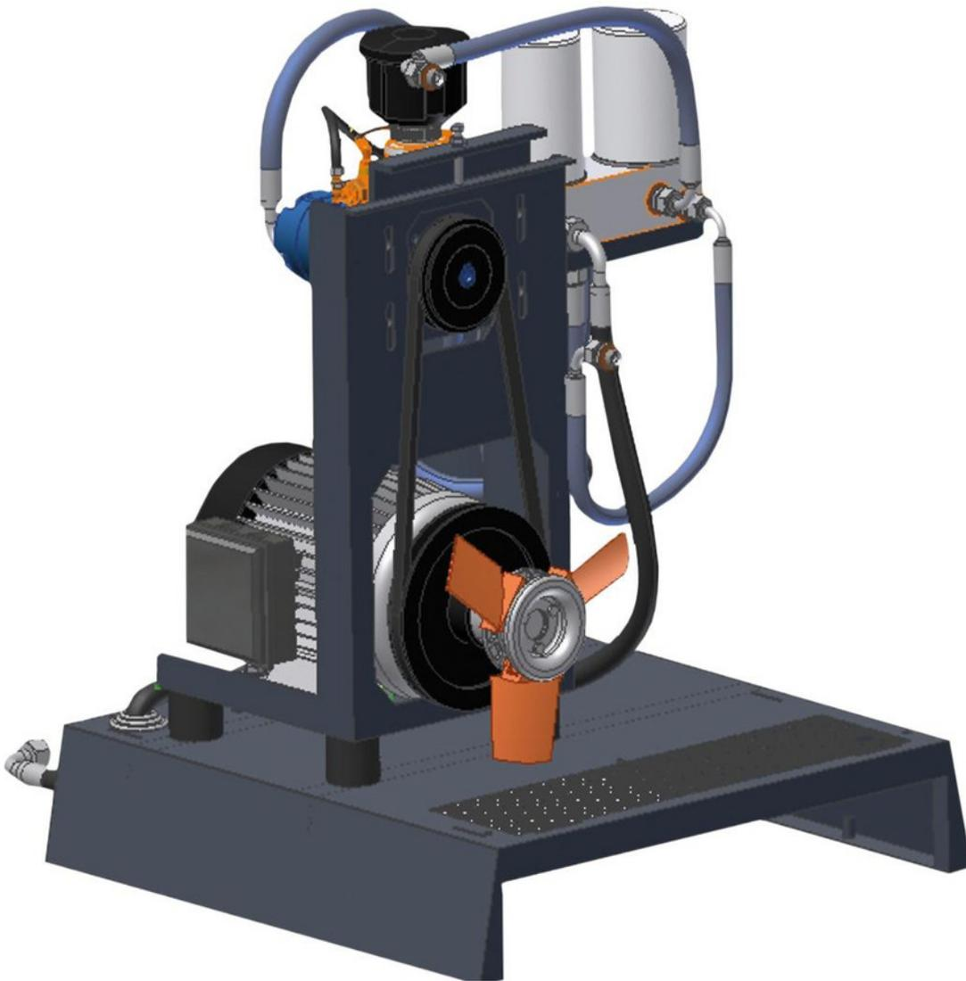
Der bewährte Riemenantrieb mit ausgewuchteten Pullys in Guss- Bauweise und hochwertigen Kegellagern sind bei allen KA- Modellen verbaut. Es sind nur die hochwertigsten Riemen verbaut um ein Maximum anVerlässlichkeit und hohe Standzeiten zu garantieren. Das ganze Riemenspannsystem wurde überarbeitet und kann nun mit einer einzigen Schraube gespannt und eingestellt werden.
