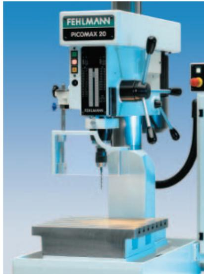
La tête porte-broche est réglable en hauteur par une manivelle, ce qui permet la compensation de différentes longueurs d'outils et hauteurs de pièces. Un guidage précis empêche tout pivotement de la tête sur la colonne, ainsi une précision de répétition de  $\pm 0.01$  mm est garantie pour le positionnement X/Y de la broche.
