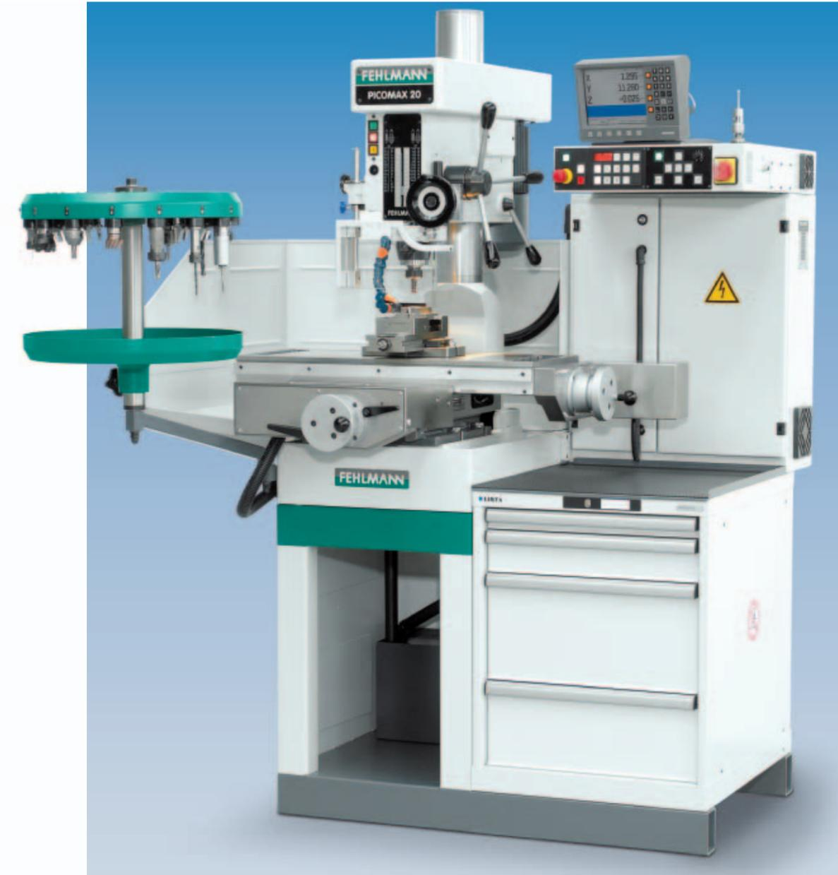
La table peut être positionnée, par des moteurs DC, en vitesse rapide, ou en avance de travail réglable en continu. Elle est équipée dans les 2 axes de fins de courses électriques et de vis à billes. Machine idéale pour la réalisation de fraisages.
