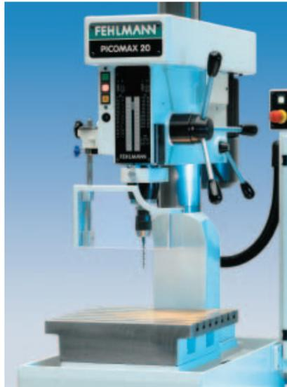
Zum Überbrücken verschiedener Werkzeuglängen und Werkstückhöhen wird der Maschinenkopf mit einer Handkurbel in der Höhe verstellt. Er ist auf der Säule gegen Verdrehung präzise geführt, so dass die ursprüngliche Position in den X/Y-Achsen mit einer Genauigkeit von  $\pm 0,01$  mm repetiert werden kann.
