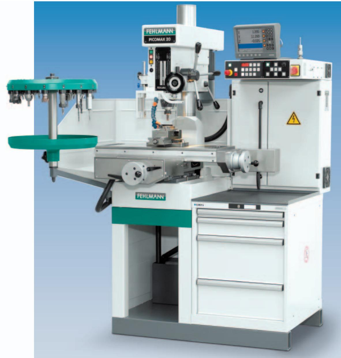
Durch die angebaute DC-Motoren ist es möglich, den Tisch im Eilgang oder mit dem stufenlos verstellbaren Vorschub zu positionieren. Der Tisch verfügt in allen Achsen über elektrische Endschalter und Kugelumlaufspindeln. Ideal zur Ausführung von Fräsarbeiten.
