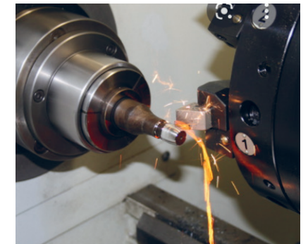
Eprouvée pour l'usinage de maté- riaux trempés
