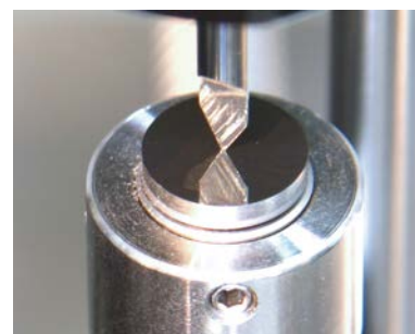
Le faible effort de palpé permet la mesure d'outils très sensibles
