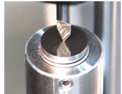
Sehr geringe Messkraft ermöglicht die Messung von sehr sensiblen Werkzeugen
