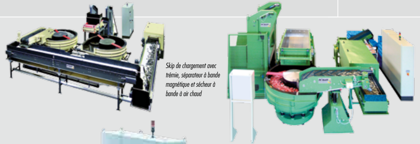
Chargement des pièces par convoyeur à bande; un second convoyeur à bande achemine les pièces traitées vers un sécheur.
