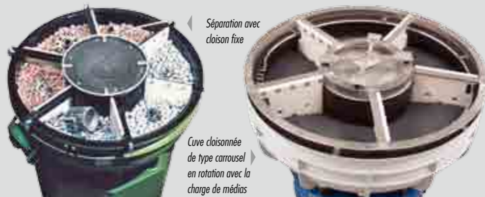
Profilés triangulaires pour éviter le collage des pièces légères contre la paroi de la cuve et les réinsérer dans la charge de médias.
