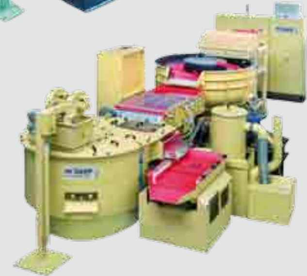
Chargement des pièces - Trémie - Lavage pièces puis séchage dans un sécheur relié à une unité de tamisage pour enlever la rafle de maïs résiduelle des pièces traitées.
