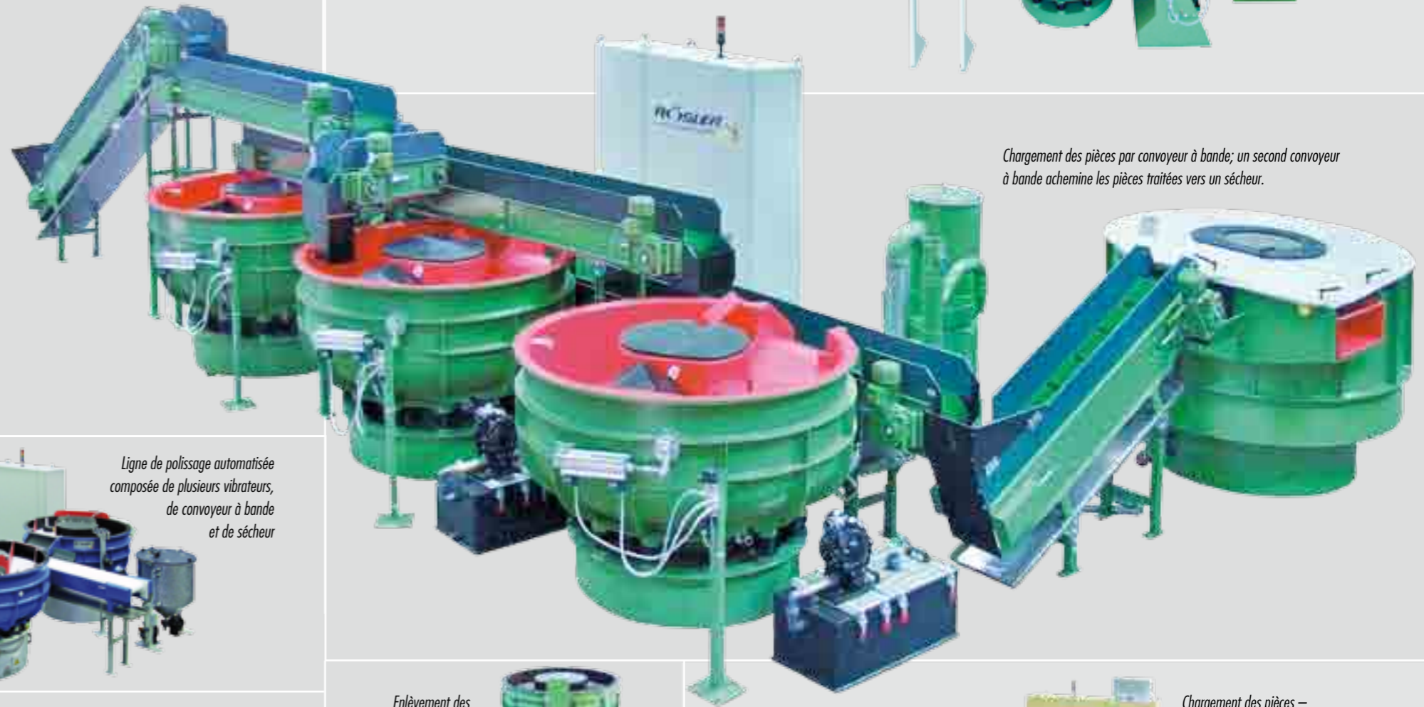
Enlèvement des pièces traitées et des médias via une trappe de déchargement pneumatique; séparation avec tambour magnétique puis séchage en sécheur
