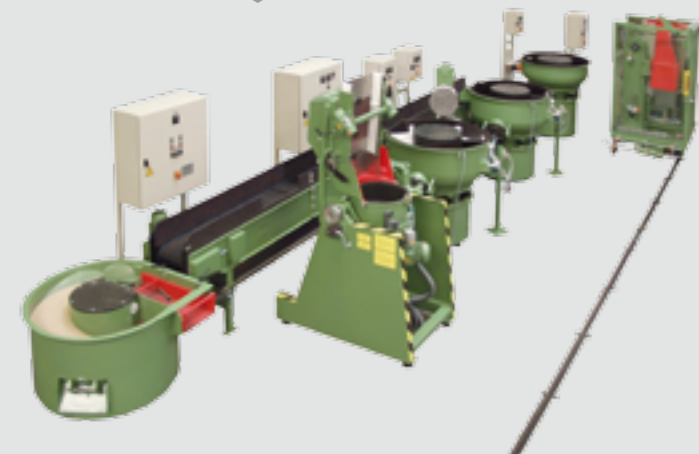
Skip de chargement de pièces sur rails avec trémie intégrée. Convoyeur à bande pour collecte et transfert des pièces traitées vers un sécheur.
