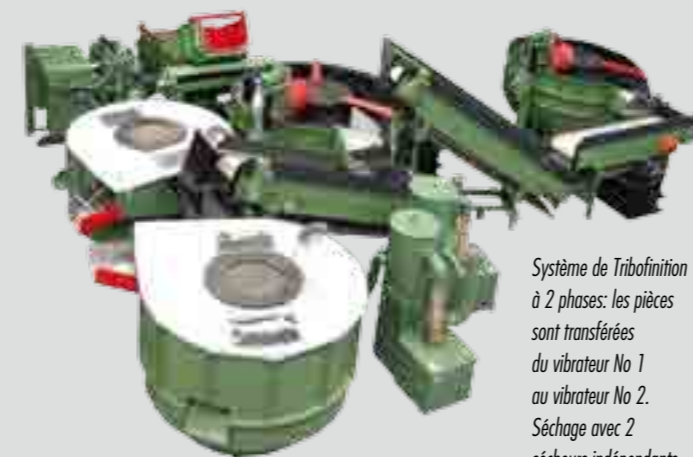
Enlèvement des pièces traitées et des médias via une trappe de déchargement pneumatique; séparation avec tambour magnétique puis séchage en sécheur
