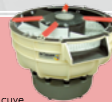
Faible chute derrière la trappe de séparation pour éviter l'endommagement des pièces fragiles
