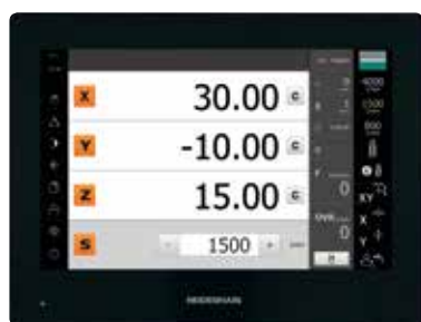
Einfache, schnelle Drehzahlverstellung über Touchscreen, Werte direkt am Display eingeben und speichern.
