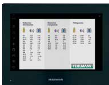
Zusatzinformationen wie z. B. Gewinde-schneidtabellen sind hinterlegt.
