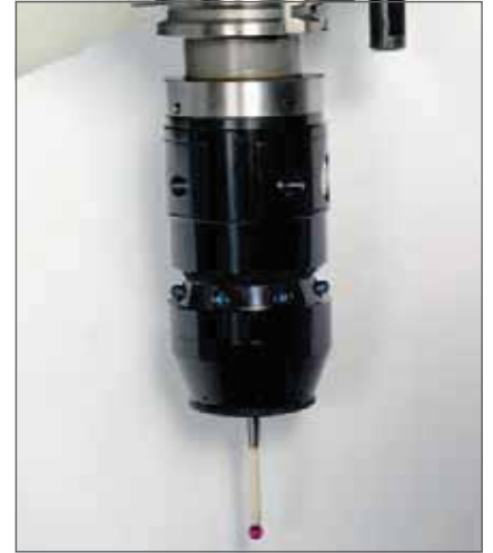
Renishaw pour mesure de la pièce Renishaw für Werkstückmessung Renishaw for piece measurement
