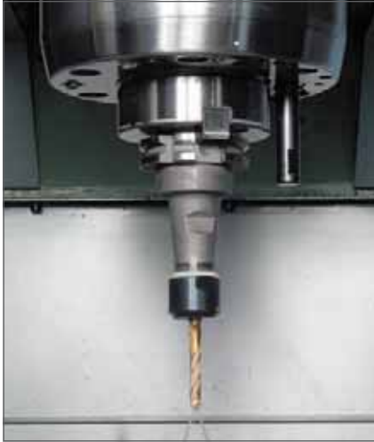
Arrosage par le centre Kühlmittelzufuhr durch die Spindel Coolant through the spindle
