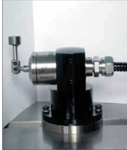
Renishaw pour mesure de l'outil Renishaw für Werkzeugmessung Renishaw for tool measurement
