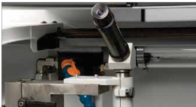
Microscope de mise à zéro / ou centrage des outils Werkzeug-Nullstellung / oder Werkzeug-Zentrier Mikroskop Tools zero setting / or centring microscopes
