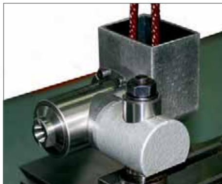
Appareil à meuler (B8) max 28'000 min -1 Schleifapparat (B8) max 28'000 min -1 Grinding attachment (B8) max 28'000 min -1
